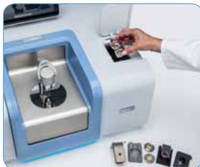
Transit™ 通道可同时支持两种实验设置, 在本例中为 ATR 和投射。
